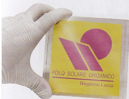
Dettaglio della Cella DSC con il logo del Polo Solare Organico.
