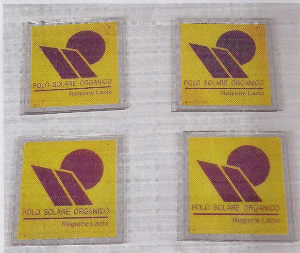
Celle DSC realizzate stampando il logo del Polo solare organico. La parte scura è quella che converte la luce solare in energia elettrica.
