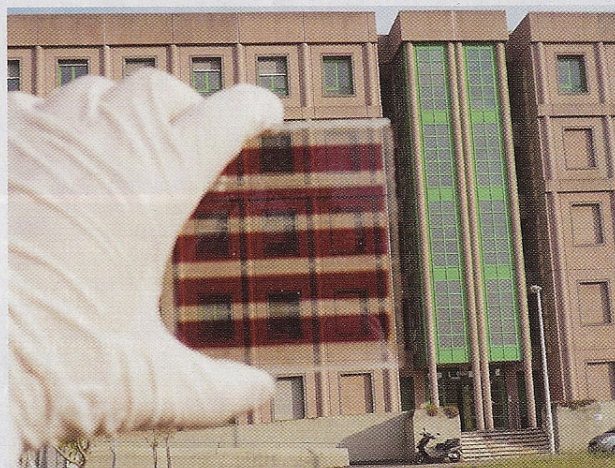
Modulo DSC a 5 celle semitrasparenti.
