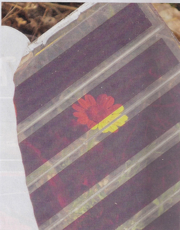
Modulo con celle sensibilizzate a colorante ( dye sensitized solar cell o DSC) formato da cinque celle semitrasparenti.
